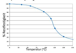
TA4302 kann bei geringen Belastungen kurzzeitig auch höheren Temperaturen ausgesetzt werden (z.B. bei Einbrennlack- oder Schwall-Löt-Verfahren). Niedrigste Temperatur bei Endfestigkeit: -40°C (abhängig von den verwendeten Materialien).
