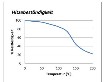
"Hitzebeständige" Scherfestigkeitsversuche wurden auf Weichstahl durchgeführt. Vor den Testversuchen wurden die Teile über 30 Minuten auf der Testtemperatur gehalten.
