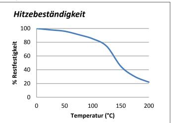
"Hitzebeständige" Scherfestigkeitsversuche wurden auf Weichstahl durchgeführt. Vor den Testversuchen wurden die Teile über 30 Minuten auf der Testtemperatur gehalten.
